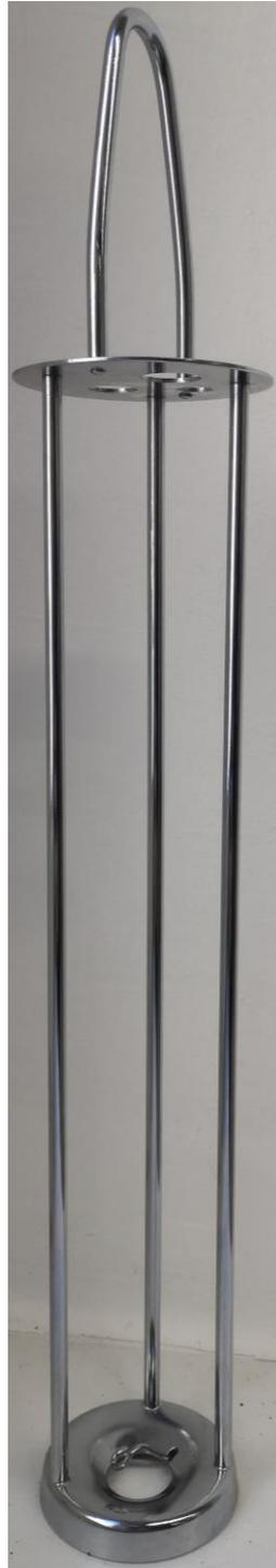
Abbildung 9: Zentriervorrichtung für Viskosimeter
